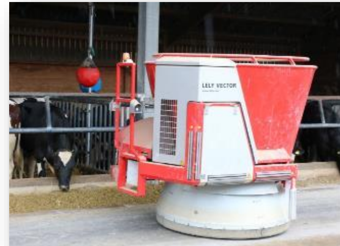
Fütterungsroboter für Bullen:
